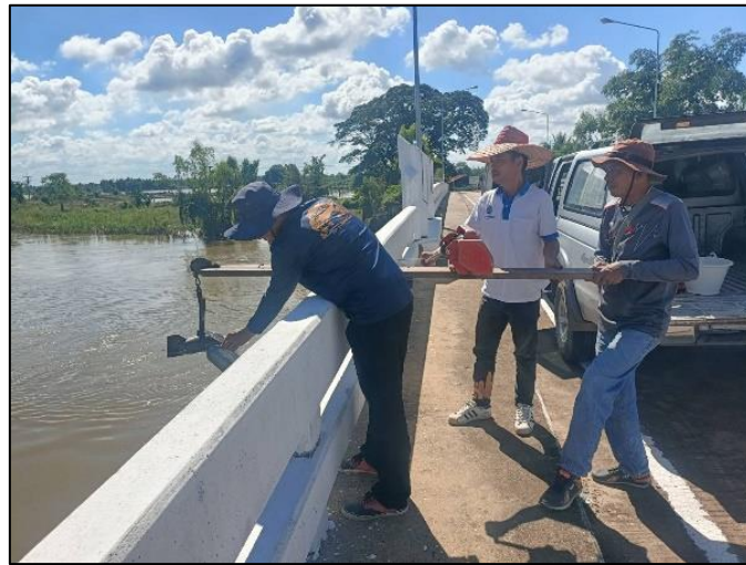
รูปที่ 5.2.6-2 การสำรวจตัวอย่างปริมาณตะกอนแขวนลอย
